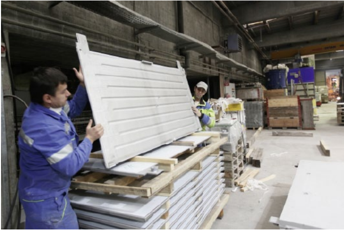
Behutsam wird das sehr dünne Wärmetauscherelement vom Stapel genommen.
